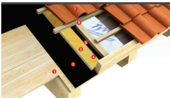
1. Placa de madera / 2. Fieltrros asfáltico / 3. Lana de vidrio / 4. Fijaciones mecánicas / 5. Contra listón / 6. Clavador / 7. Tejas
